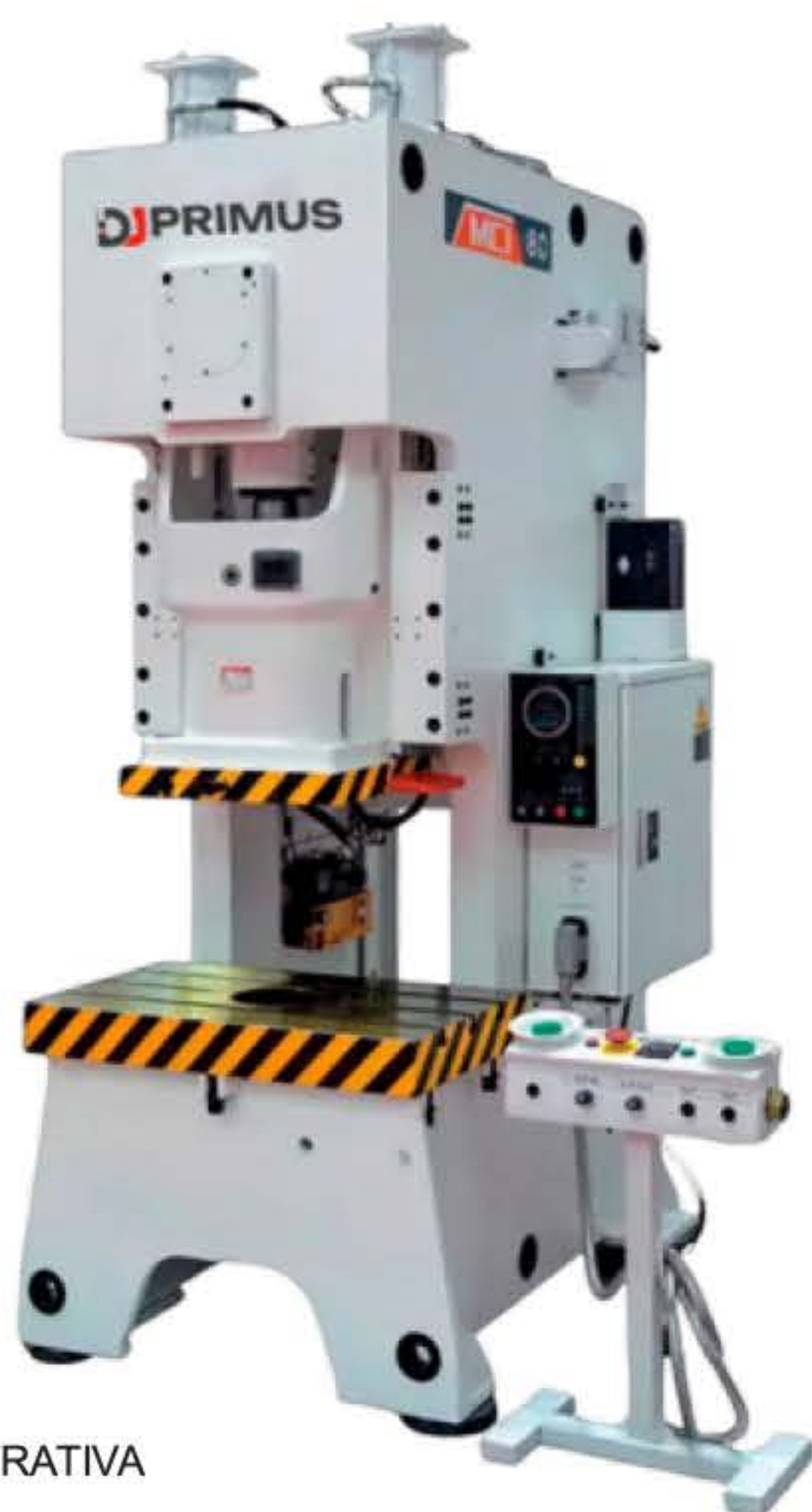
PRENSA MODELO MC 1 CAP.: 25T Á 400T
